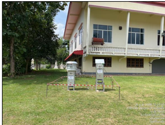
รูปที่ 3.2 การเก็บตัวอย่างคุณภาพอากาศในบรรยากาศ บริเวณ วัดศรีวนาลัย (A2)
